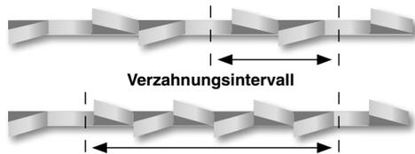
Universell einsetzbar für Schnittstärken ab 5 mm bei Stahl, Guss und harten NE-Metallen. Konstante Zahnteilung: Schränkfolge links / rechts / gerade, variable Zahnteilung: Pro Intervall mindestens ein Zahn ungeschränkt, die restlichen Zähne im Intervall sind wiederkehrend links / rechts oder in umgekehrter Reihenfolge geschränkt.
